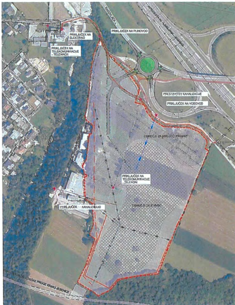
Slika 29: Prikaz predvidenih infrastrukturnih priključkov
