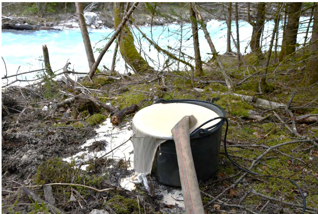
Slika 6: Iztok podzemne vode med črpanjem iz vrtine PZP-2/21.
