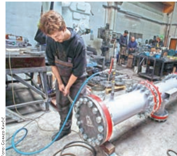
Separator, ki so ga izdelali na Jesenicah in ga bodo uporabljali na črpališču zemeljskega plina v Sibiriji
