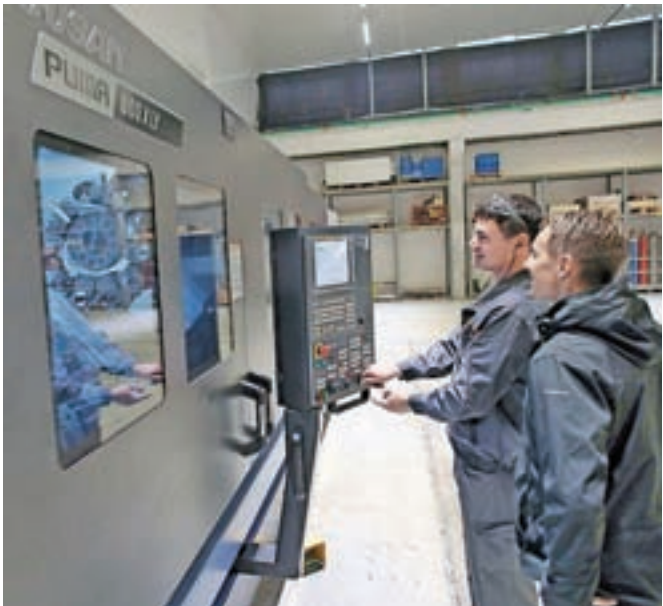
Najnovejši investiciji sta nova hala in najmodernejša CNC-stružnica za obdelavo jeklenih profilov velikih dimenzij.
