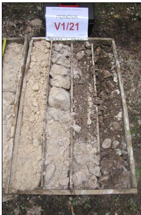
Slika 15, Slika 16: Jedro vrtine V1/21 (8 m ← 0 m)
