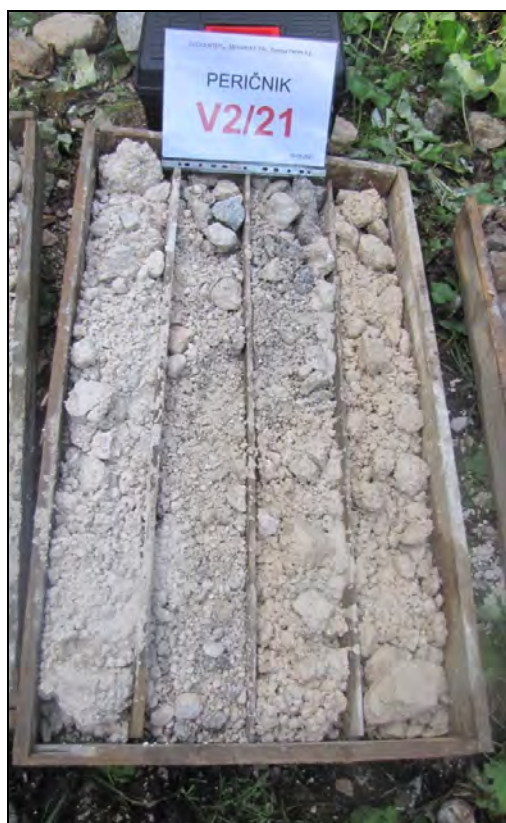
Slika 8, Slika 9: Jedro vrtine V2/21 (8 m ← 0 m)
