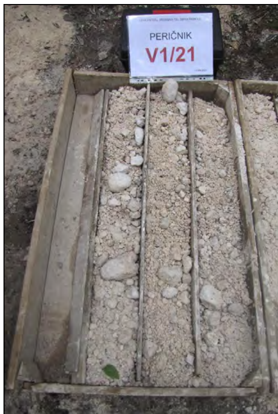
Slika 17, Slika 18: Jedro vrtine V1/21 (15 m ← 8 m)
