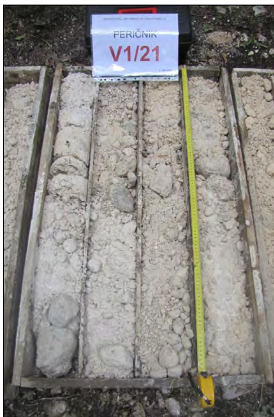
Slika 15, Slika 16: Jedro vrtine V1/21 (8 m ← 0 m)
