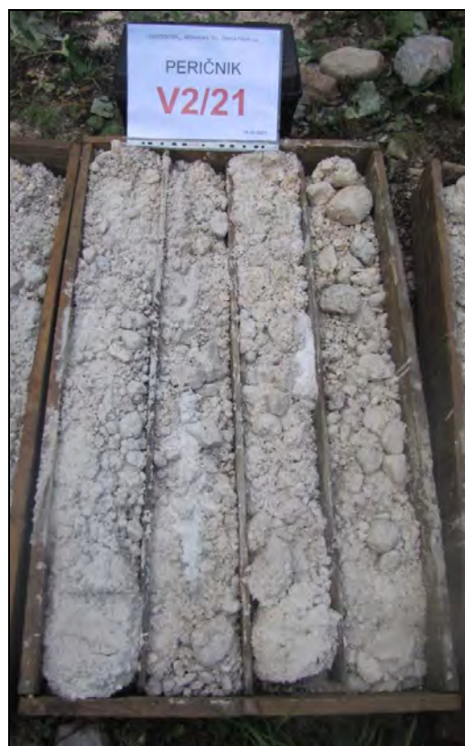
Slika 10, Slika 11: Jedro vrtine V2/21 (15 m ← 8 m)
