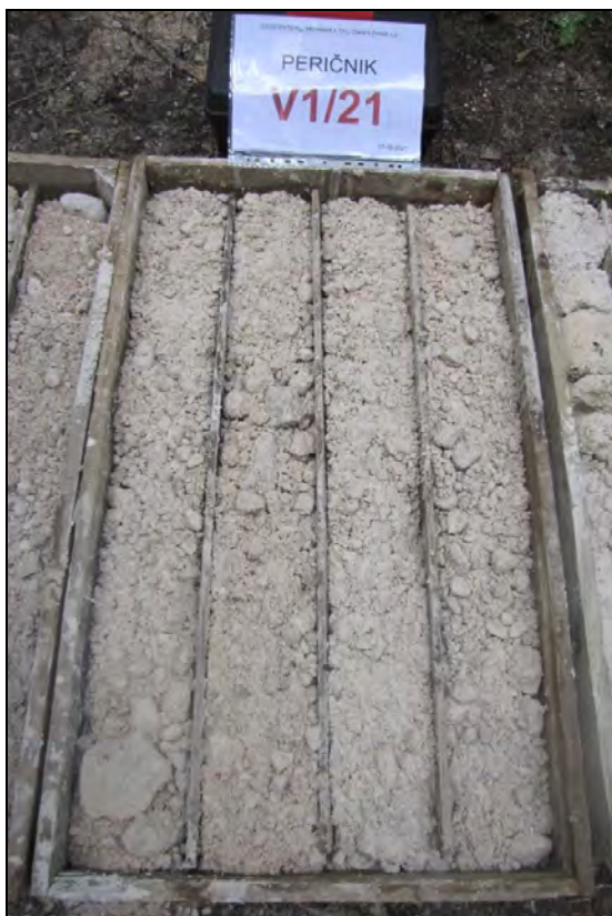
Slika 17, Slika 18: Jedro vrtine V1/21 (15 m ← 8 m)
