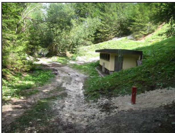
Slika 25, Slika 26: Piezometer V3p/21 s kapo in obešanko (vir Peček, foto 18.08.21)
