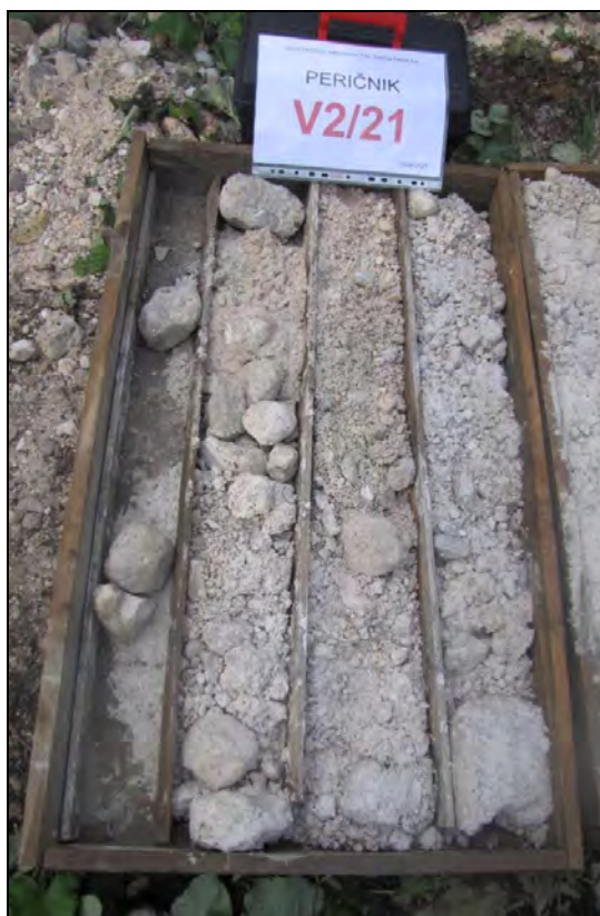
Slika 10, Slika 11: Jedro vrtine V2/21 (15 m ← 8 m)
